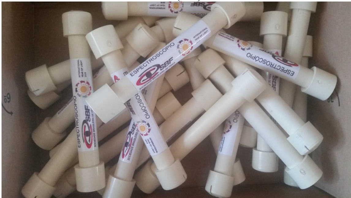
Figura 34 - Espectroscópios feitos de cano PVC fornecidos pela Sociedade Brasileira de Física (SBF).
