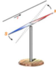
Em 1819 o físico dinamarquês Hans Christian Oersted trabalhando com circuitos elétricos, percebeu que a passagem de corrente elétrica por um condutor causava deflexão no a agulha de uma bússola posicionada próxima. O deslocamento da agulha de uma bússola, normalmente acontece de acordo com o campo magnético da terra, e o movimento ocorrido nesta situação só podia ser creditado ao aparecimento de um novo campo magnético.
