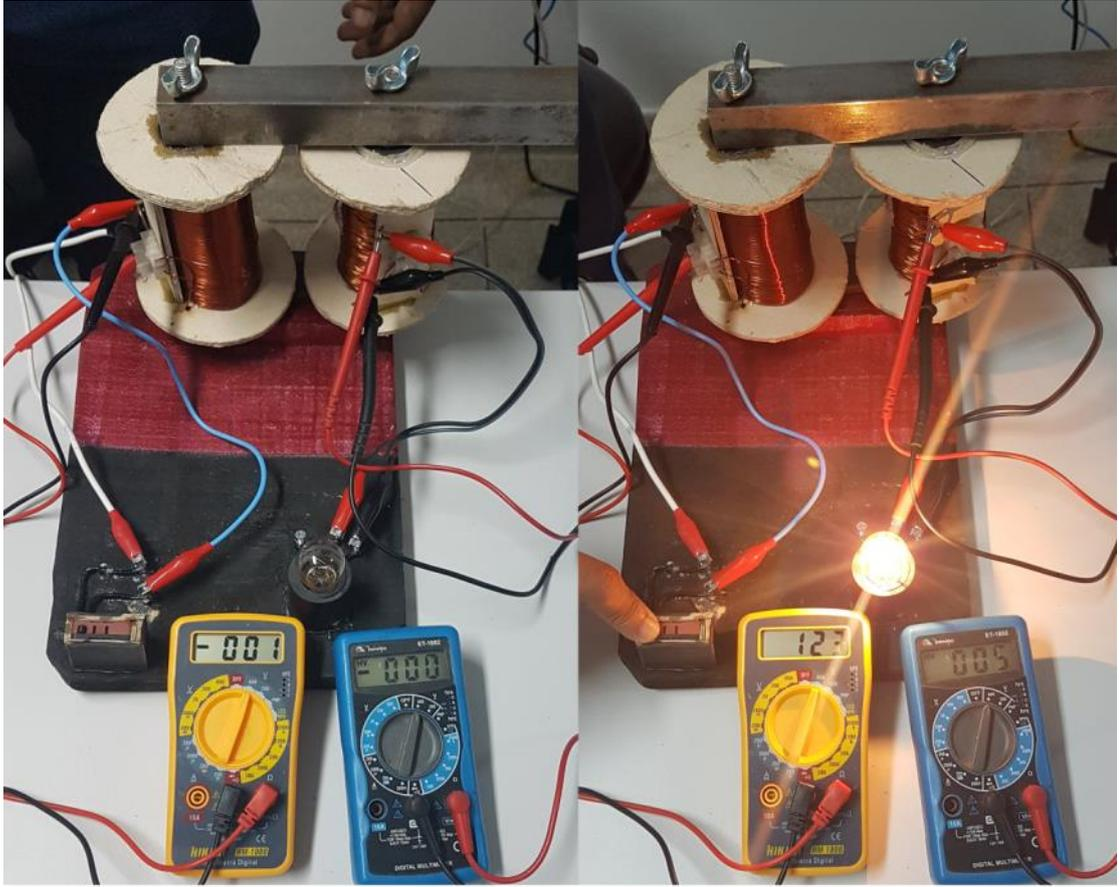
Finalmente, haverá a apresentação do experimento “Forno de indução eletromagnética” que trata das correntes parasitas, suas aplicações e consequências, após a exibição, enfatizar que a produção e transmissão de energia elétrica estão baseadas nos conceitos de indução eletromagnética.
