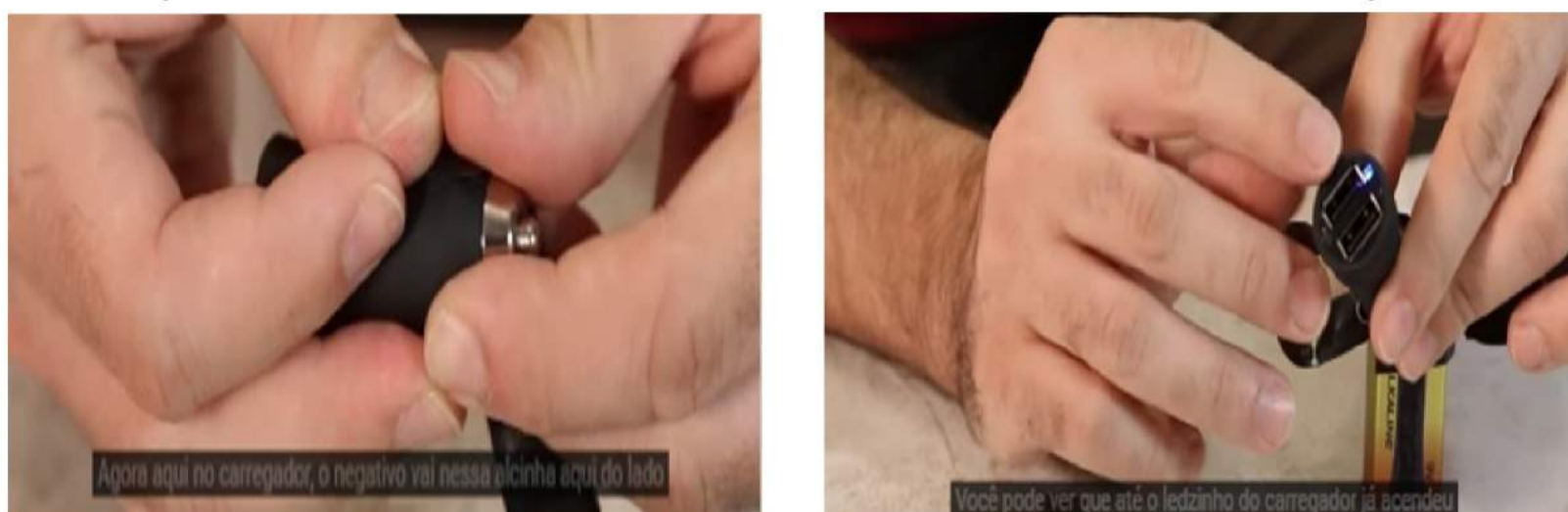
Figura 51: Conexão da fita metálica na bateria 9v e carregador 12v.
