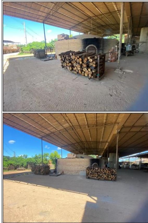
**Figura 15** - Suportes de toras para controle de quantidade de madeira queimada
