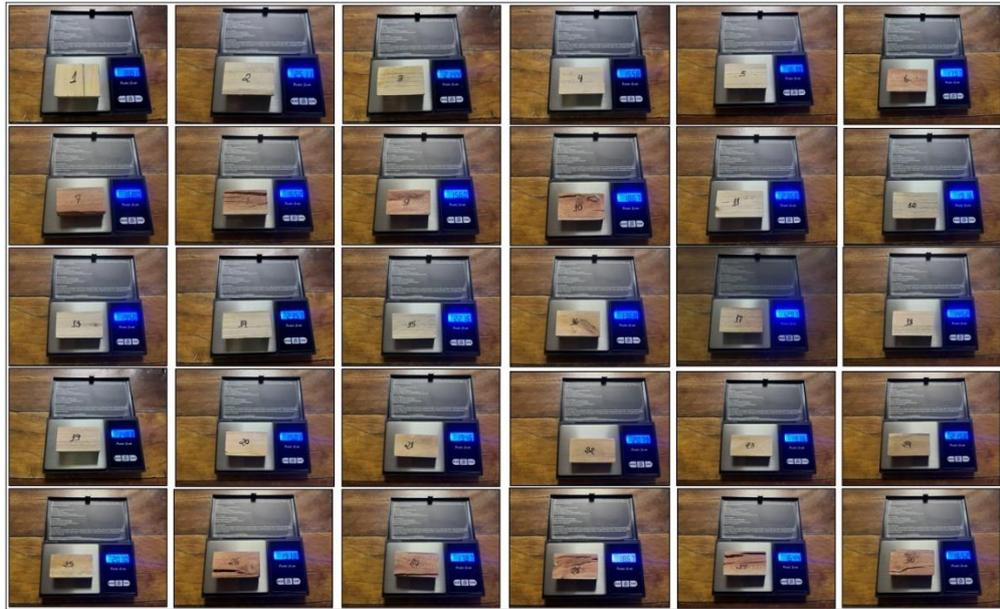
**Figura 29** - Pesagem dos corpos de prova após 18 horas de secagem
