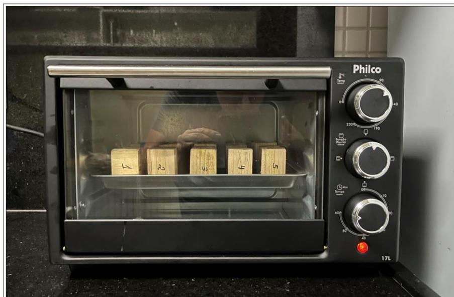
**Figura 26** - Secagem dos corpos de prova
