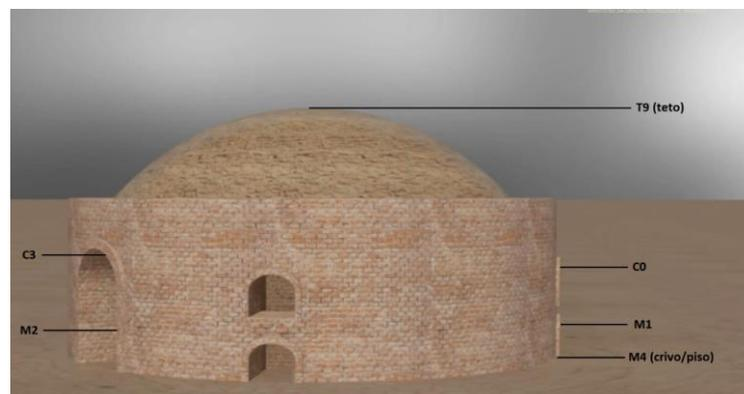
**Figura 18** - Posicionamento dos termopares instalados no forno em estudo
