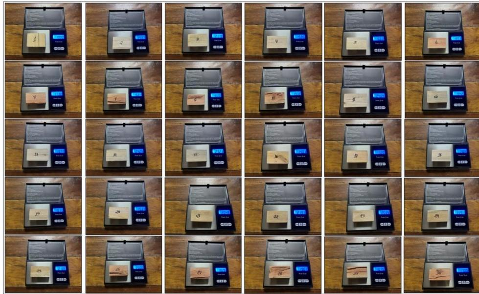
**Figura 27** - Pesagem dos corpos de prova após 6 horas de secagem
