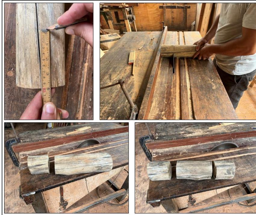
**Figura 21** - Esquema para extração dos copos de prova (NBR 7190)
