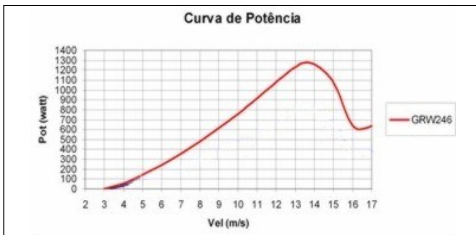
Gráfico 17: Curva de potência do aerogerador GRW246. Fonte: ENERSUD. Disponível em: http://www.enersud.com.br/produtos.asp
