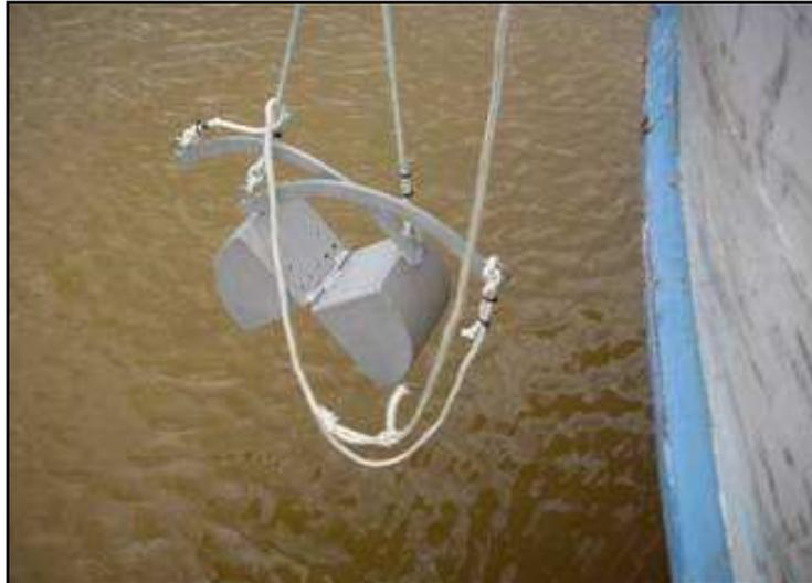
Figura 4. Draga tipo Van Veen utilizada na coleta dos sedimentos do estuário do Rio Macaé.
