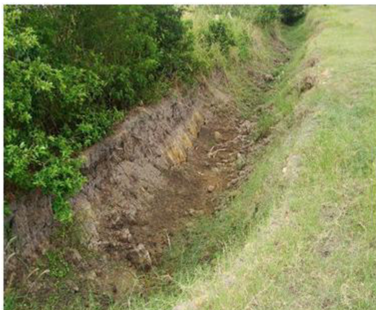
Figura 08 – Valão de prospecção para estimativa do potencial da jazida. Foto: do autor
