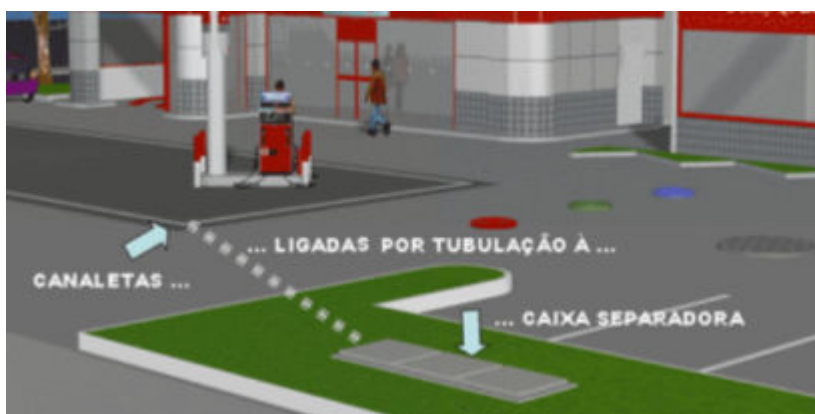
FIGURA - Sistema de canaletas ligadas ao SAO. Fonte: Texaco, 2011.
