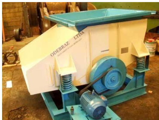
Figura 35: Peneiras Vibratórias Fonte: MF RURAL.
