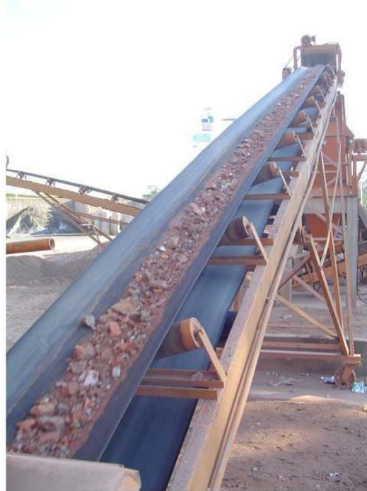
Figura 34: Transportador de correia Fonte: MF RURAL.
