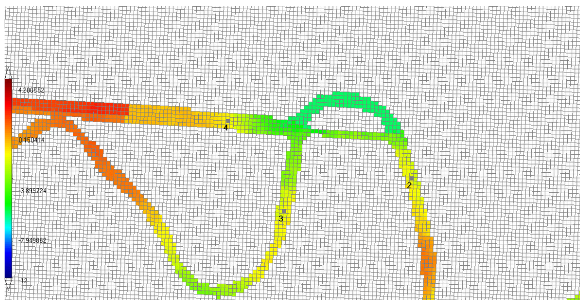
Figura 17: Detalhe do terreno digital criado no MOHID. Fonte: Elaborado pelo Autor, com o software MOHID.
