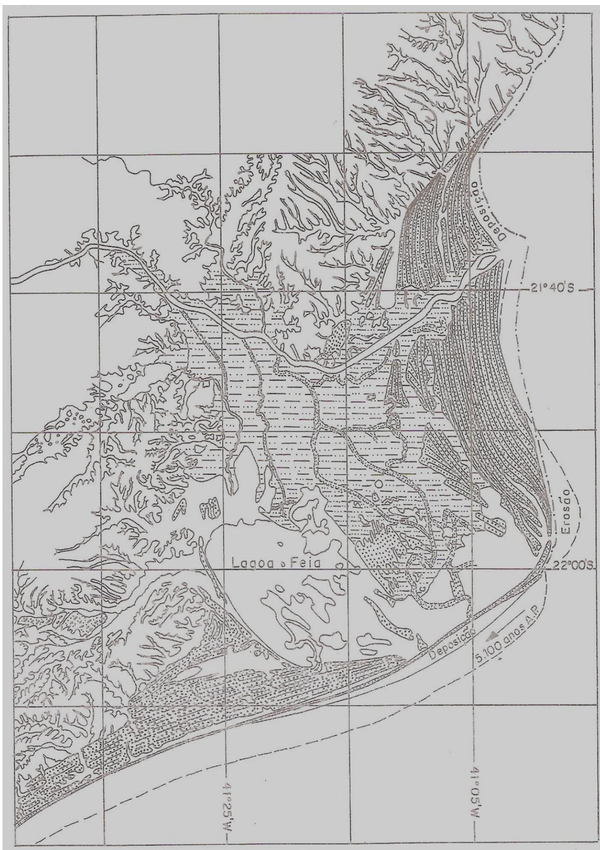
ANEXO 17: Estágio 12- Fase de intenso retrabalhamento dos últimos depósitos, com erosão local e sedimentação em outra parte, no período 2.500 anos A.P. até hoje. Fonte: FAPESP, CPRM – Serviço Geológico do Brasil.
