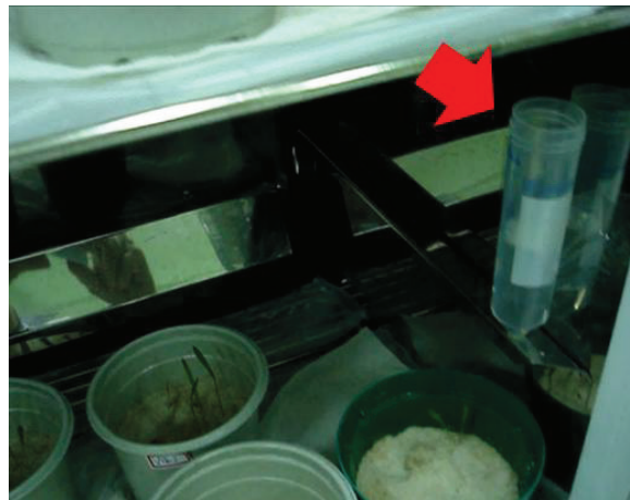
Figura 9 - Tubo para centrifuga (seta) com 30 ml de água para minimização da evaporação promovida pela ventilação forçada no interior da B.O.D.
