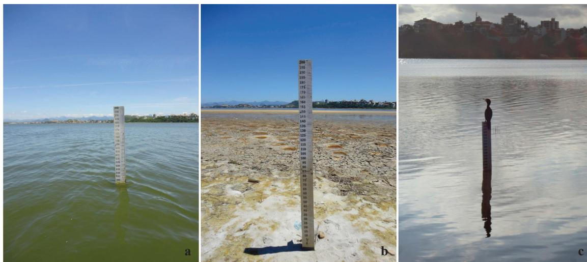
**Figura 11.** Variação do nível da lagoa Imboassica antes e após a abertura da barra. Em “a”, o registro fotográfico foi feito em dezembro de 2011, com a barra ainda fechada. Em março de 2012 (“b”), após sua abertura artificial e fechamento natural, a escassez hídrica do corpo d’água ainda era perceptível. Em junho do mesmo ano, a lagoa encontrava-se cheia novamente (“c”).
