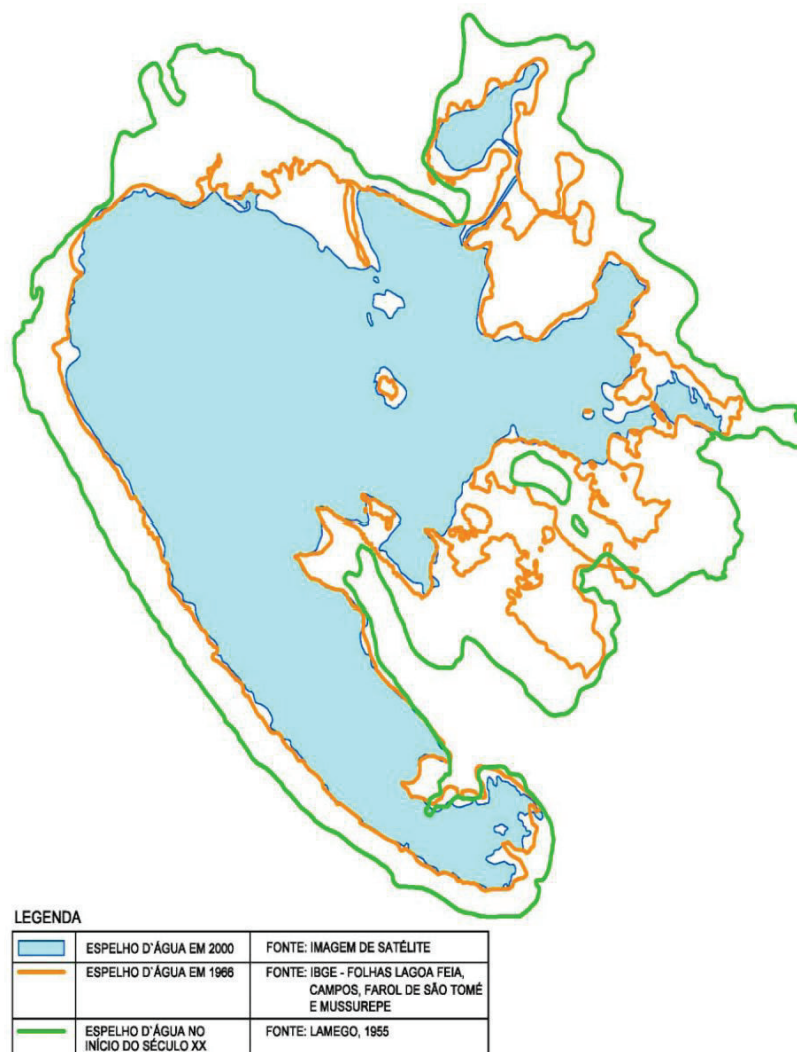
Figura 7: Redução do Espelho D'Água da Lagoa Feia em função das intervenções de drenagem ao longo do século XX. Fonte: Bidegain, Bizerril & Soffiati Neto (2002).
