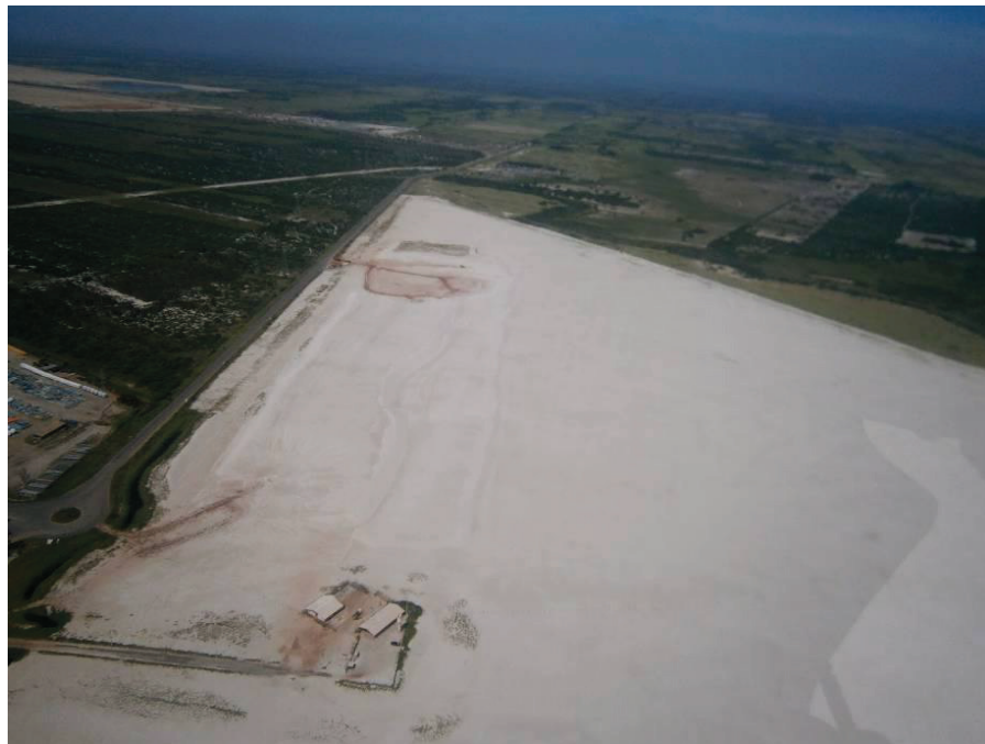
Figura 8 – Aterro hidráulico. Fonte: Roberto Moraes, 2013.
