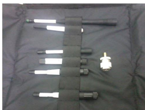
Figura 8: antenas padrão (fonte: autor)
