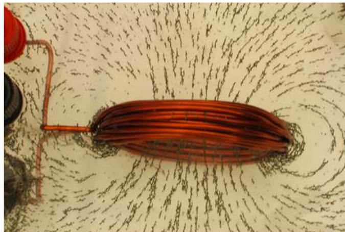
Figura 12: Bobina feita a partir de fio esmaltado
