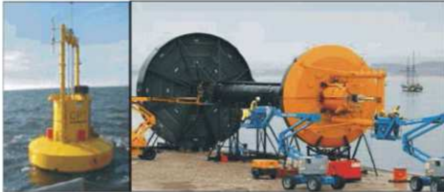
Figura 3: Esquema do WEC Point Absorber
