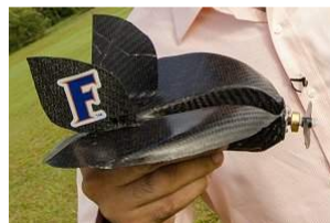
Este é o mais simples dos veículos autônomos, feito de fibra de carbono e carregando uma câmera a bordo. [Imagem: Eric Zamora/University of Florida]
