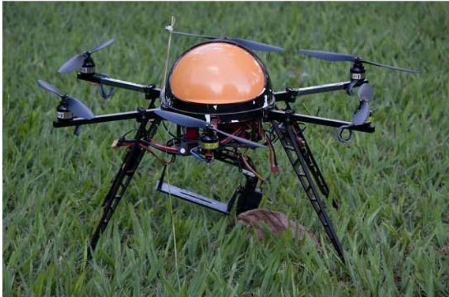
O protótipo pesa 2,5kg e tem um metro de diâmetro, podendo voar a altura máxima de 150 metros. [Imagem: Salvador Júnior/UnB Agência]
