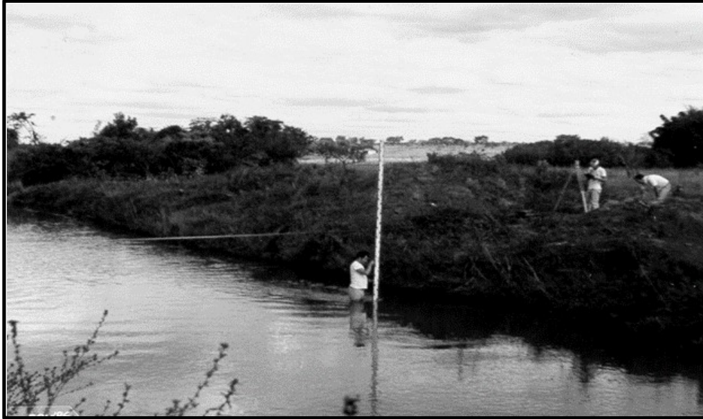
FIGURA 3: Règua graduada - medida de profundidade com régua no Rio Salitre – Bacia do rio Paranaíba (ANA, 2009)
