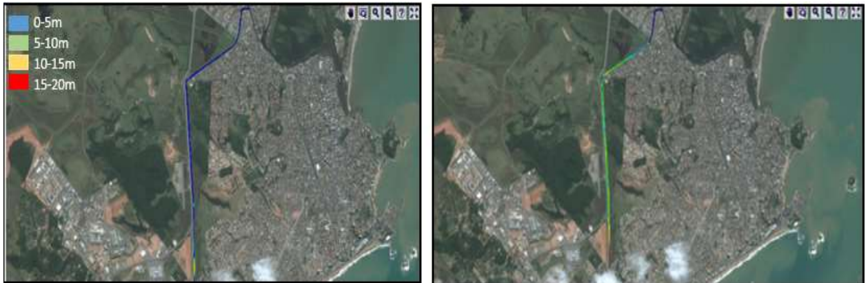
FIGURA 8 – Representação das topobatimetrias: em relação ao elipsoide na figura à esquerda e em relação ao geoide à direita.
