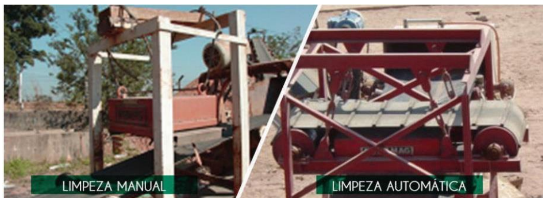
Figura 4: Separadores Magnéticos Fonte: ABRECON, 2017.
