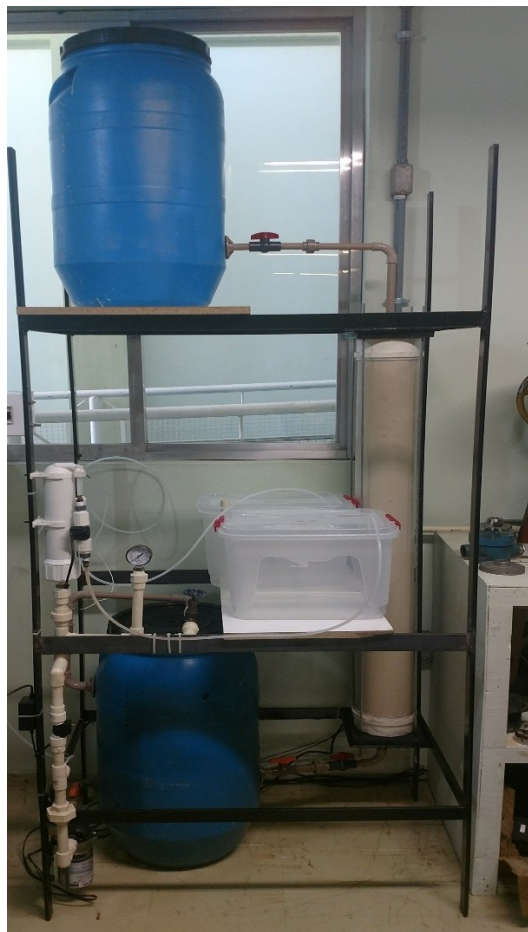
Foto 1: Protótipo Experimental do Dessalinizador por Osmose Reversa Fonte: Fotografada pelo autor
