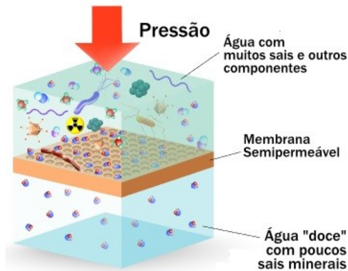
Figura 7: Funcionalidade da Membrana para Osmose Reversa Fonte: Brasil Escola (2015) 7
