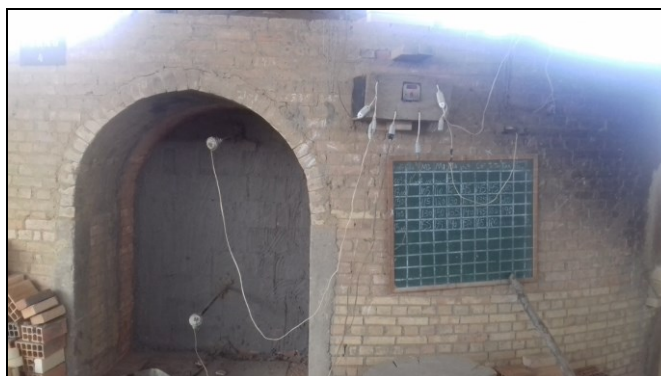
Figura 1 - Procedimento manual de coleta da temperatura do forno.
