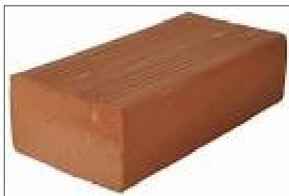
Figura I – Exemplo de tijolo maciço de cerâmica vermelha sem deformidades
