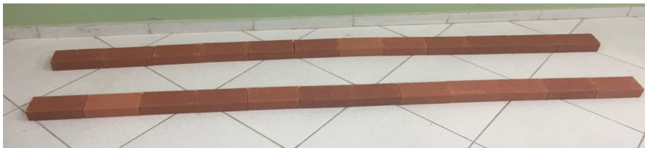
Figura II – Procedimento de medição das dimensões dos tijolos maciços
