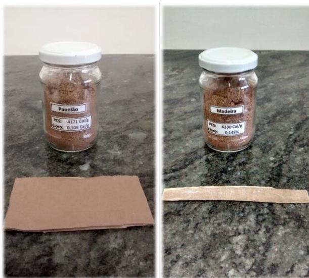
Diante dos resultados dos testes laboratoriais, foi possível quantificar os valores de PCS e Teor de Cloro, para os produtos segregados, conforme **Quadro 1**:
