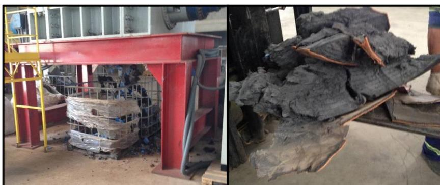
Na segunda linha de picagem a espuma e a borracha foram picadas a uma granulometria de 0,5 mm, granulometria esta, capaz de suprir a necessidade de sua destinação final, que seja, a queima em fornos Clínquer, que são os fornos das Cimenteiras (**Figura 14**).
