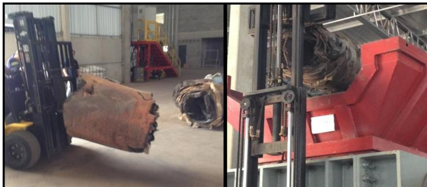
A capacidade do triturador utilizado foi de 1,5 t/h, porém, os materiais saíram com uma granulometria alta para sua destinação final (**Figura 13**).
