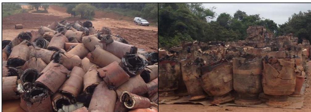
Após os mangotes serem picados pela tesoura hidráulica, de modo a ficarem separados em anel e flange, foi feita a descaracterização e separação do flange e os metais que o compõem. Esta separação foi feita com a utilização de um maçarico oxi-corte (**Figura 11**).
