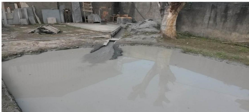
Figura 4: Ponto 2 Saída de água da serra maior e entrada no primeiro tanque de decantação
