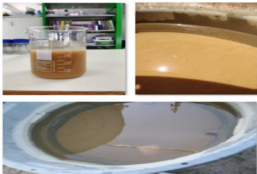
Figura 12 – Visão de decantação do LETA em reservatório e amostra
