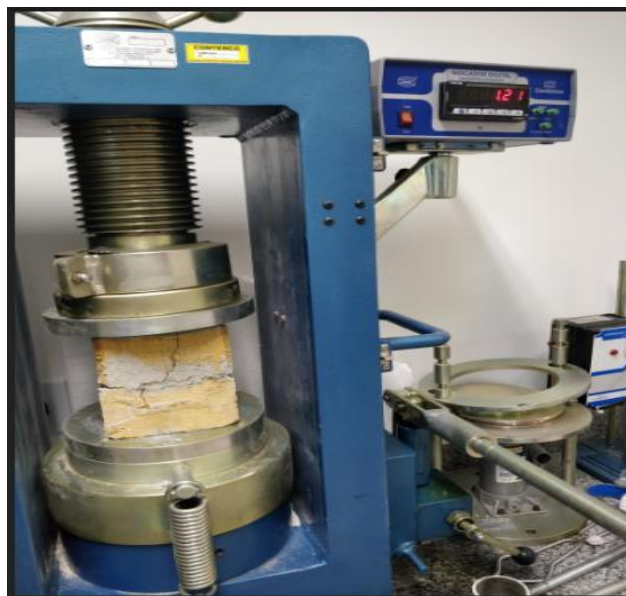
Figura 18 – Ensaio de Compressão simples
