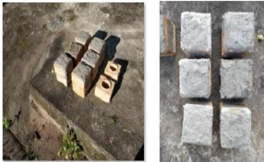
Figura 17 – Capeamento dos tijolos
