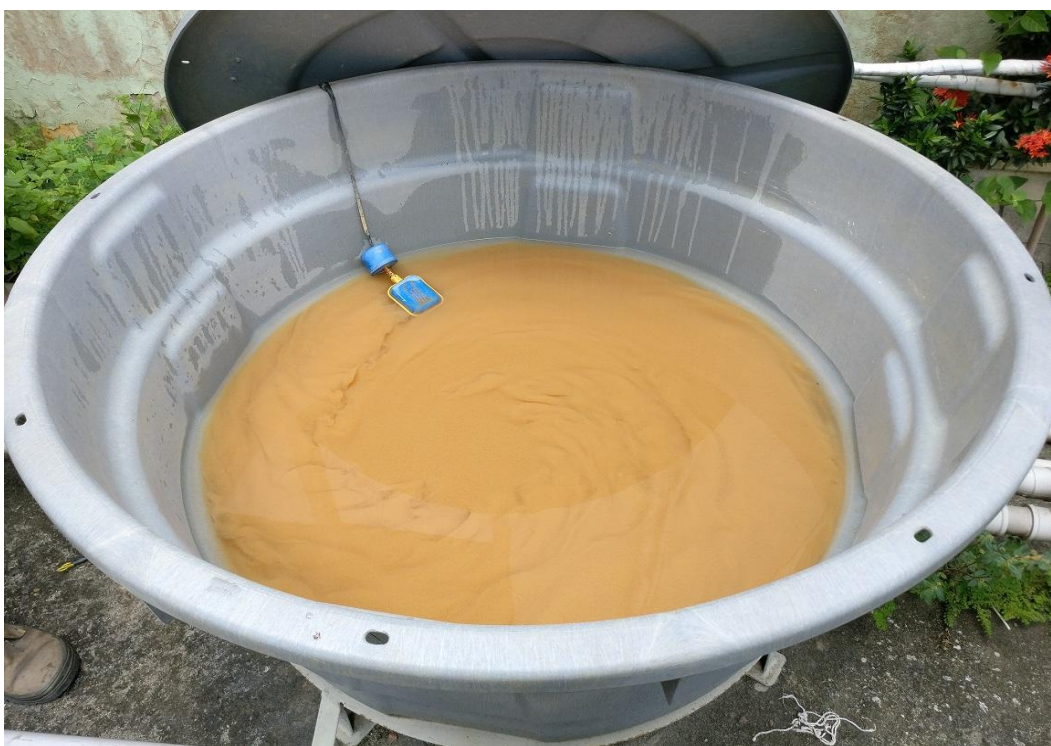
Figura 04 – Exemplo de armazenamento de lodo de ETA – IFFLUMINENSE Polo de Inovação Campos Dos Goytacazes.
