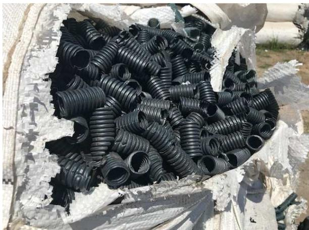
Figura 12 – Material filtrante utilizado nos tanques aerados para remoção de Matéria Orgânica na ETE Mutum – Fonte: Próprio Autor
