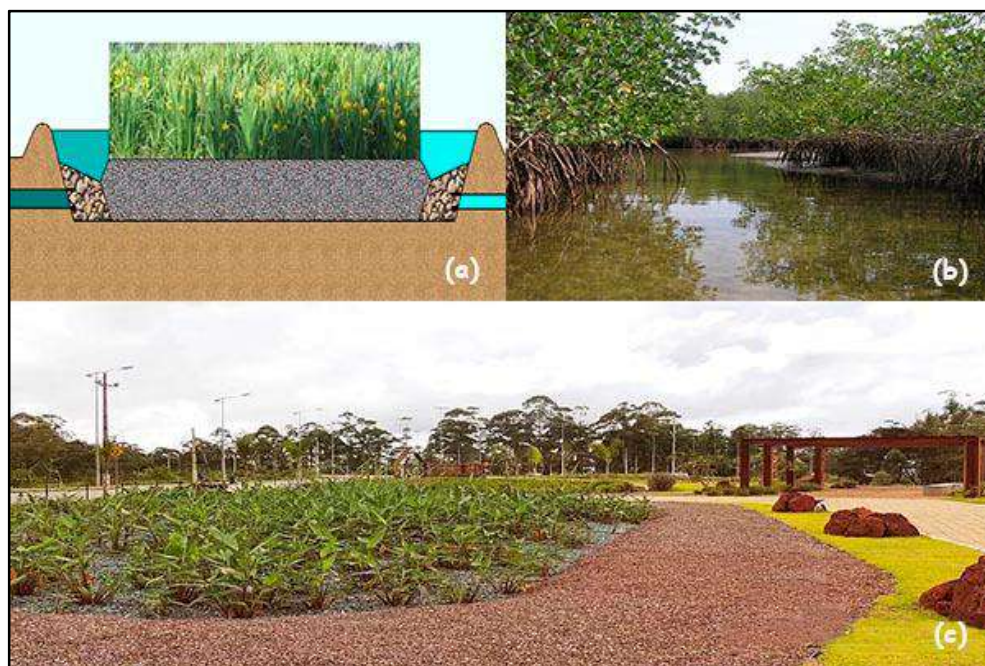
Figura 15: (a)Esquema de Wetlands ; (b) Wetland Natural e (c) Wetland Construído Fonte: (a) Kilianwater ; (b) Wetlands International e (c) Wetlands Construídos
