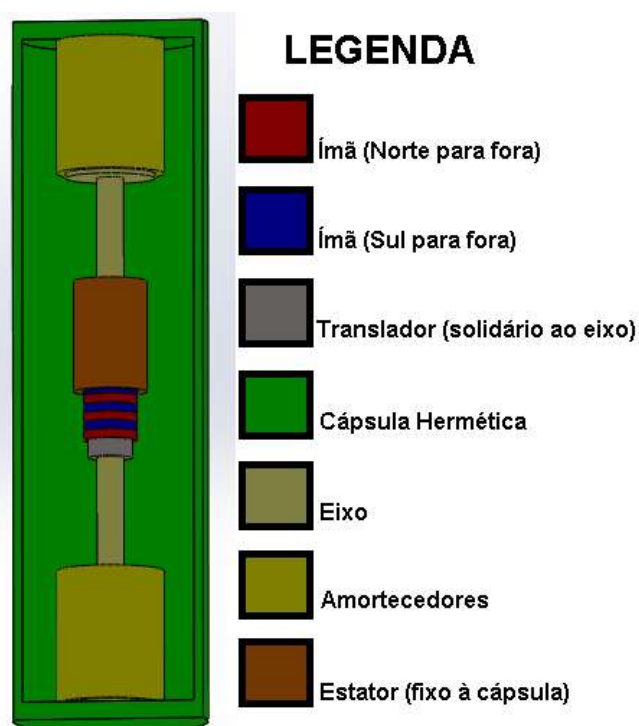
Figura 1 – Esquema básico de um absorvedor pontual
