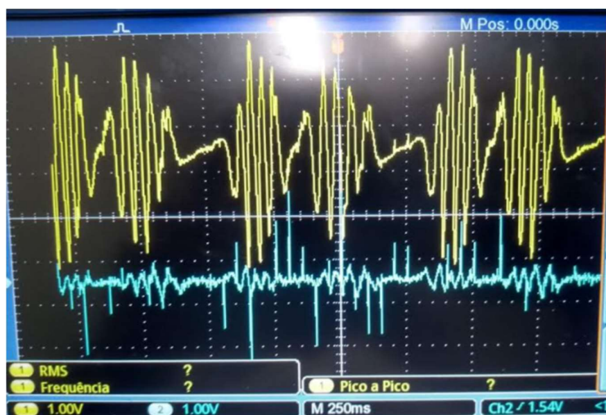
Figura 10 – Tensão gerada no protótipo de gerador de relutância variável
