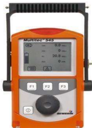
Figura 9 – Analisador de biogás
