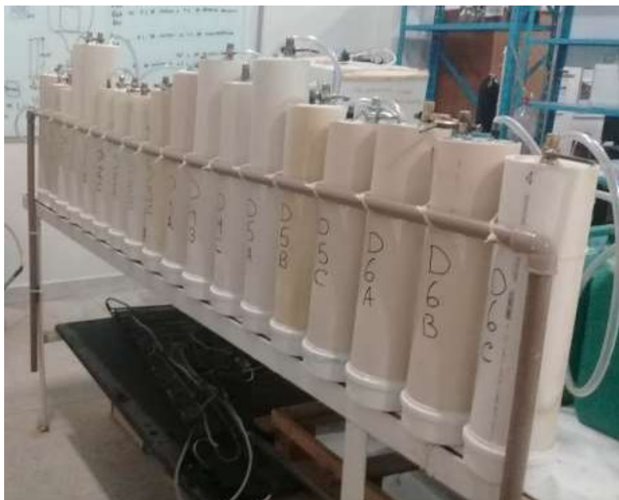
Figura 4 – Digestores de bancada utilizados no experimento.
