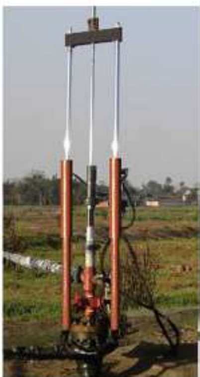
Figura 15: Protótipo de laboratório de um bombeio hidráulico para testes onshore
