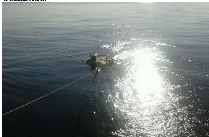
Figura 5. Rede utilizada durante um arrasto horizontal teste nas águas superficiais na Baía de Guanabara.
