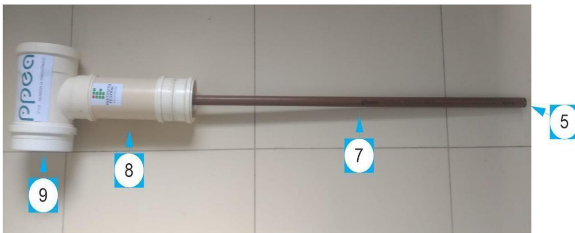
Figura 16 – Protótipo 1.0 – Sensor Ultrassônico a prova d'água – AJ-SR04M
