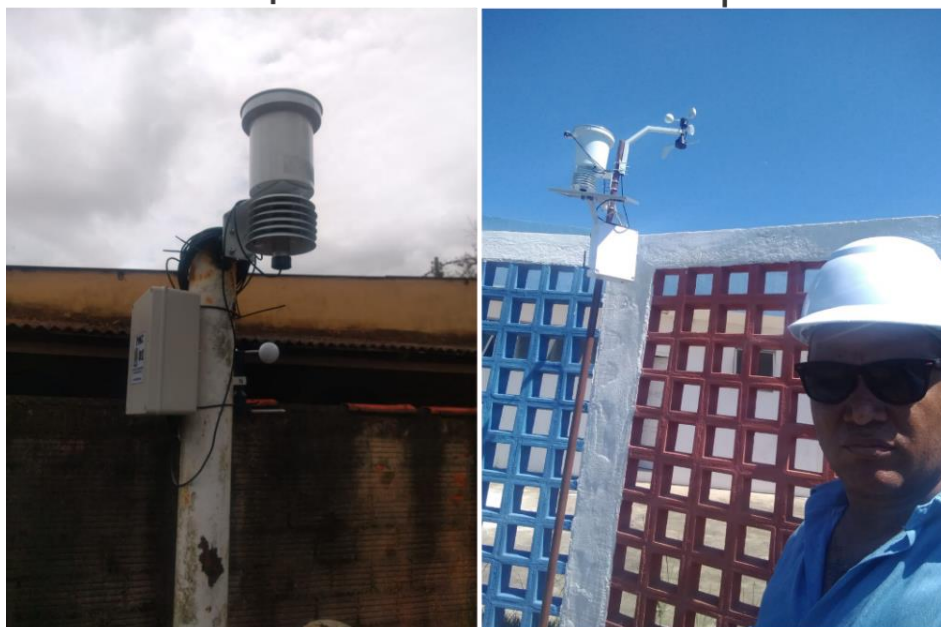
Figura 11 – Evolução da estrutura da Estação meteorológica e componentes Protótipo-1 Protótipo-4
