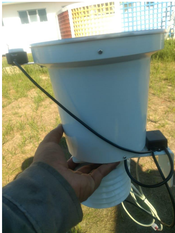
Foto 7 – Pluviômetro de bscula e sensores de temperatura e umidade da Est Meteorolgica
