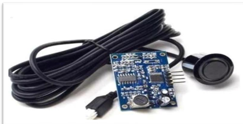
Figura 10 – Sensor Ultrassônico a prova d'água
