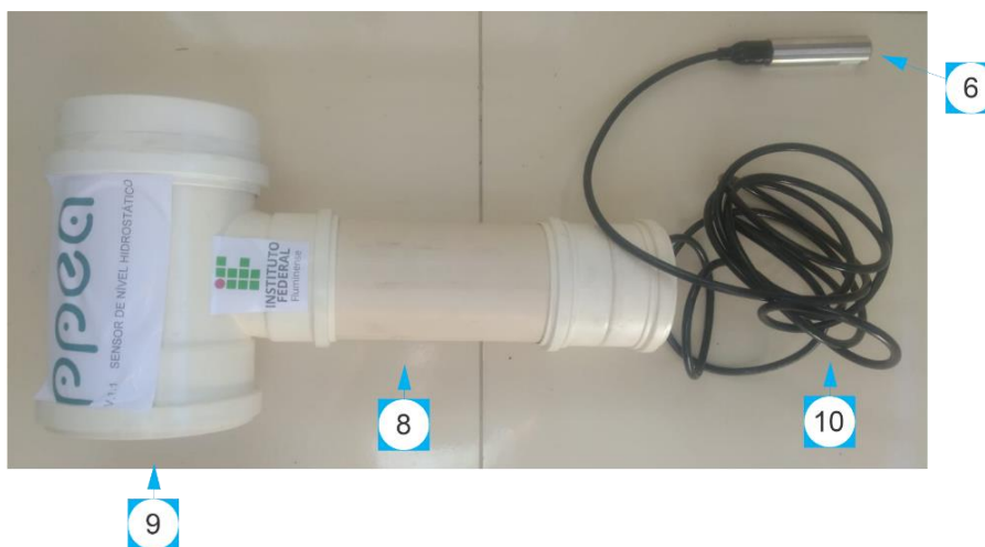
Figura 18 – Protótipo 1.1 – Sensor de nível hidrostático montado
