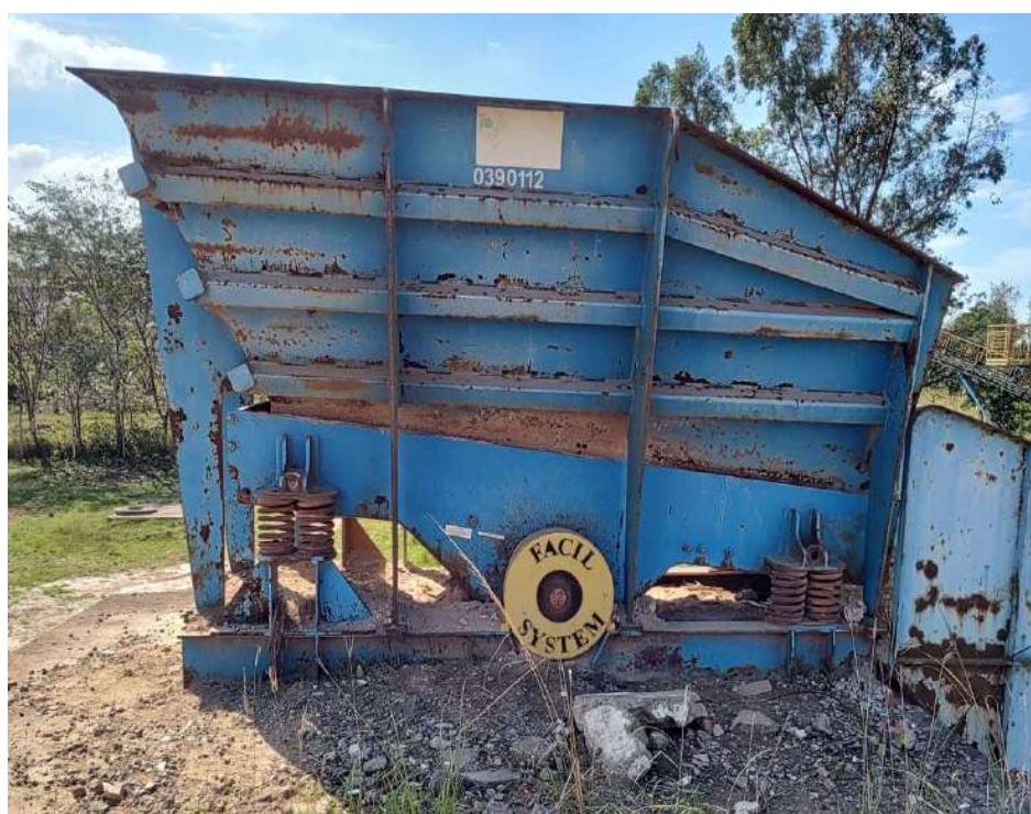
Figura 32: Equipamento alimentador vibratório.
