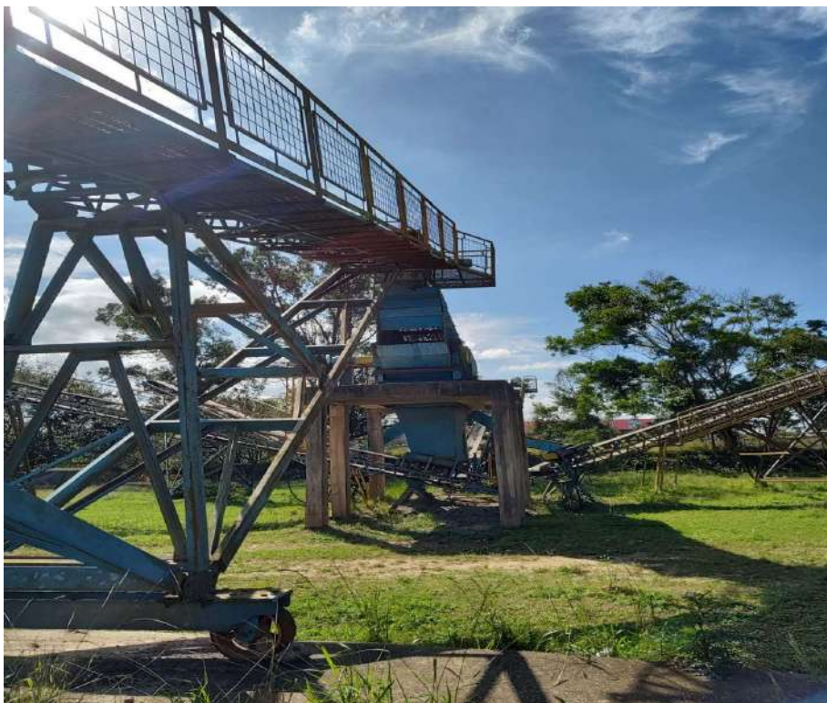
Figura 41: Peneira separadora e as quatro saídas dos reciclados.
