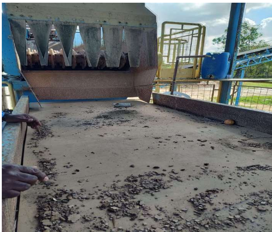
Figura 34: Saída da transportadora e mesa separadora
