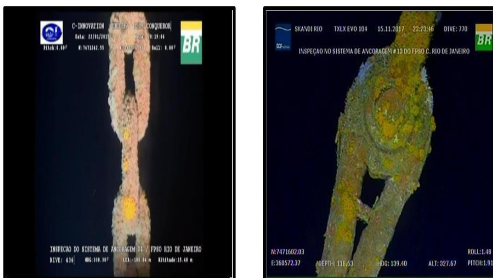
Figura 4 – Presença de colônias de Coral-sol em linhas de ancoragem na P-07
