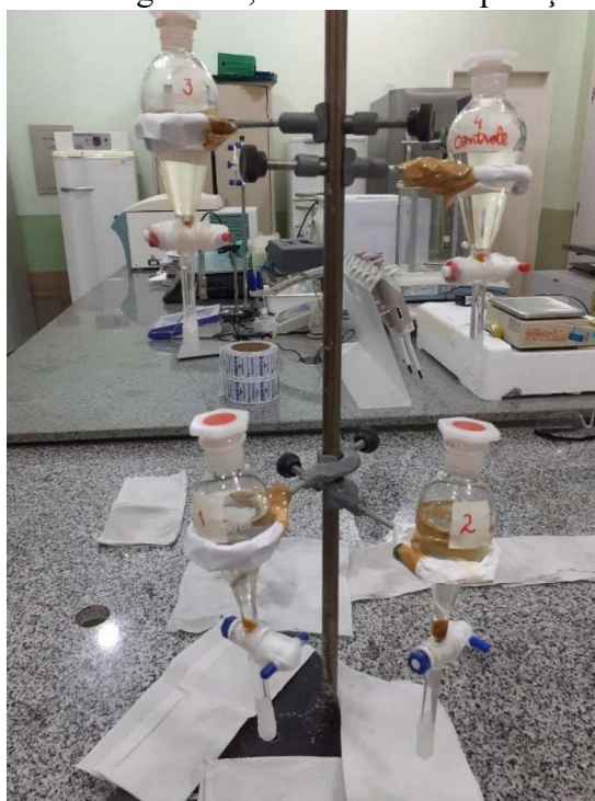
Figura 38 – Amostras em processo de sedimentação de matérias sólidas de microplásticos das matérias orgânicas, em funis de separação.
