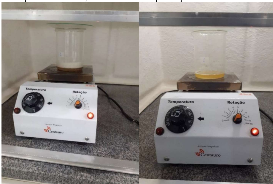
Figura 34 – Registro da amostra 1 da 1ª coleta sendo aquecida a 75^\circ\text{C} , na placa de aquecimento por 30 minutos, e o seu resultado após o período definido.
