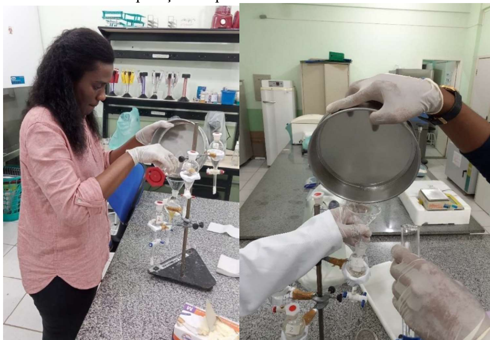
Figura 37 – Amostras sendo transferidas para seus respectivos funis de separação, na finalidade de se obter a separação do plástico.
