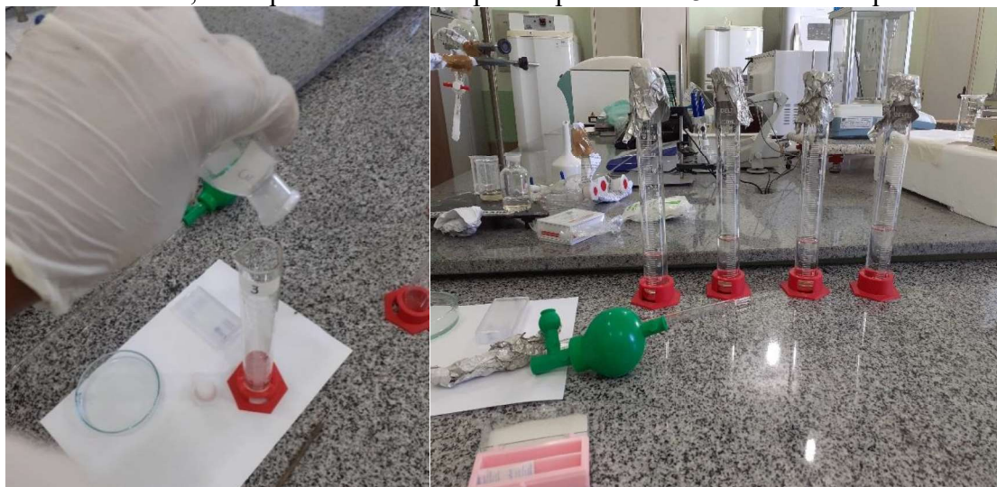
Figura 41 – Registros de transferência de solução homogênea de NaCl [aq] e resíduos sólidos, do separador de funil para a proveta na 3 a coleta do experimento.
