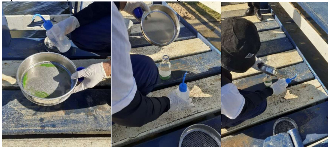
Figura 21 – Transferência de resíduos sólidos através do despejo de água destilada na peneira de 53 \mu\text{m} no Ponto 1 - Cais da Lagoa Imboassica.
