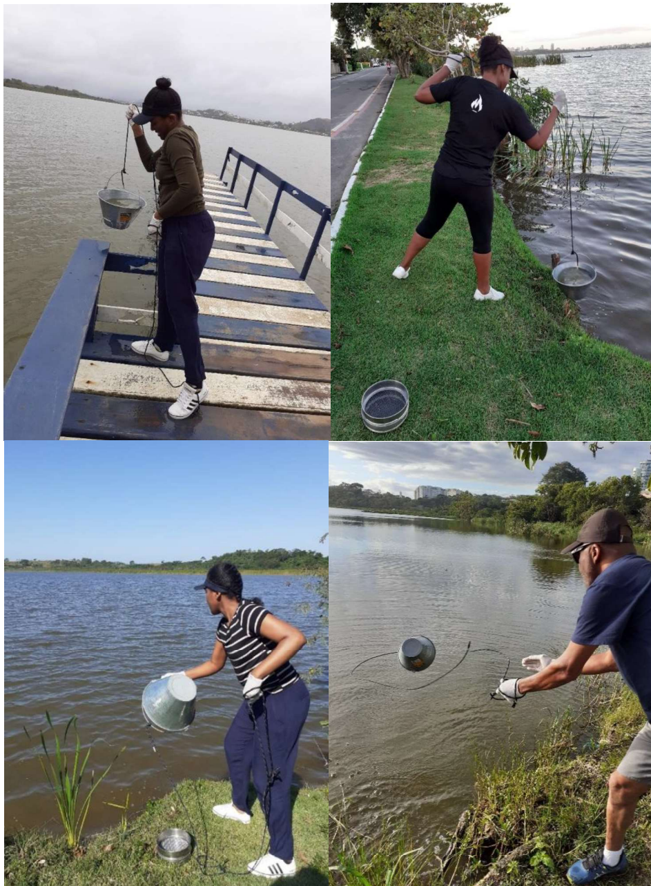
Figura 20 – Coletas em superfície de amostras de água nos três pontos geográficos do experimento.
