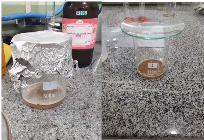
Figura 33 – Reação à temperatura ambiente de 20 mL de \text{FeSO}_4 e de \text{H}_2\text{O}_2 nas amostras 1 da 1ª e 2ª coleta do experimento.
