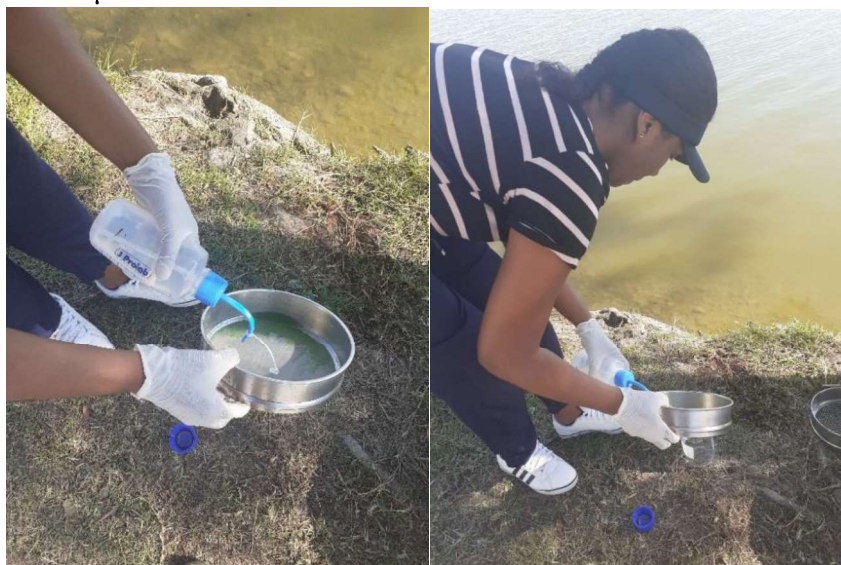
Figura 22 – Transferência de resíduos sólidos através do despejo de água destilada na peneira de 53 \mu\text{m} no Ponto 2 – Rua Anfilóbio Trindade.
