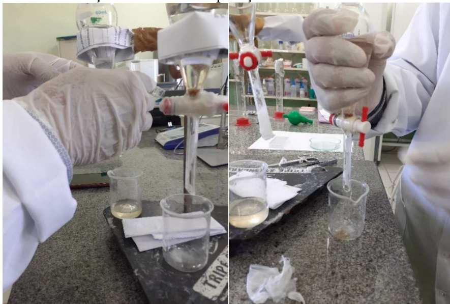
Figura 39 – Etapa de eliminação de material orgânico da solução NaCl [aq], pelo processo de sedimentação no funil de separação.
