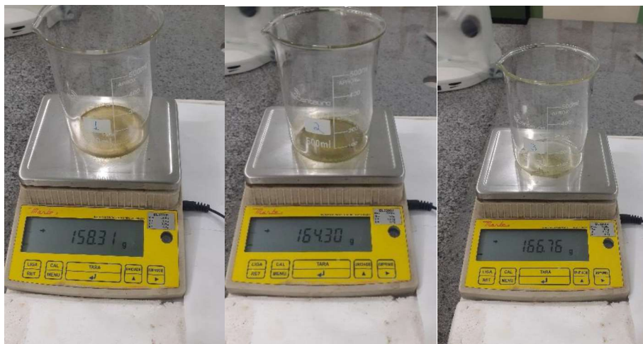
Figura 30 – Registro da obtenção da massa seca das amostras 1, 2 e 3 da 1ª coleta do experimento.
