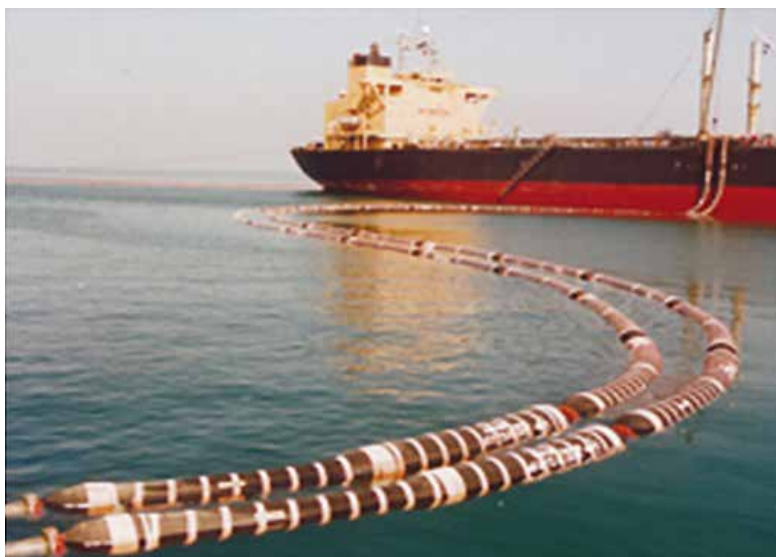
Figura 4: Bombeamento de petróleo com Floating Hose
