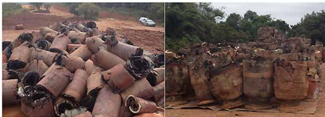
Figura 10: Floating Hoses separados em anel e flange
