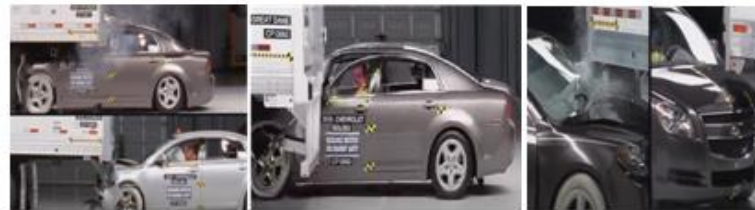
Figura 01 – Teste de impacto envolvendo carros e caminhões
