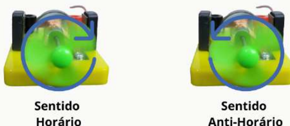
FIGURA 17 - Hélice alternando o sentido de giro.
