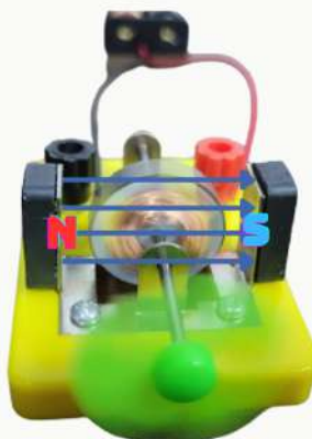
FIGURA 16 - Hélice girando devido ao campo magnético externo.
