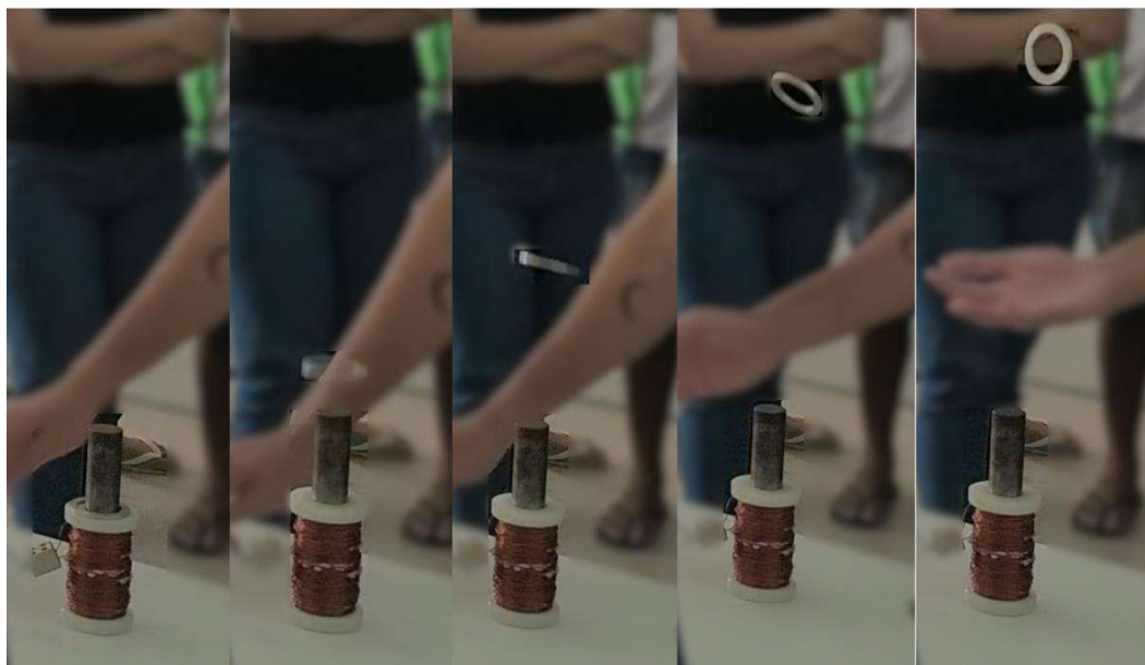
Figura 41 - Experimento do anel de Thomson sendo realizado.
