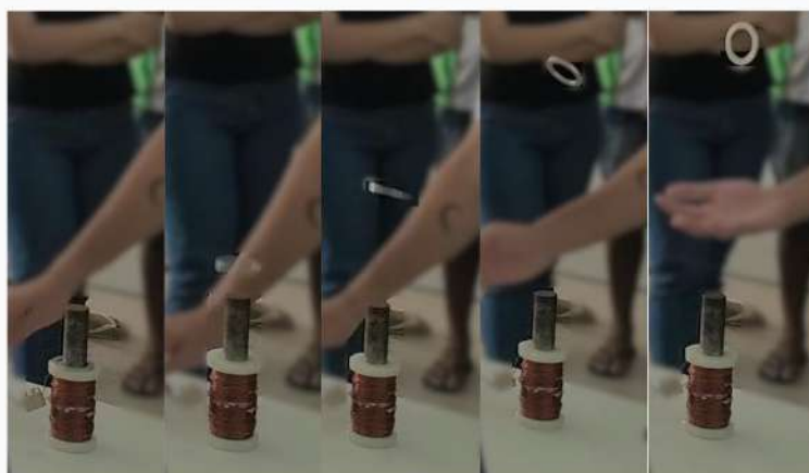
FIGURA 22 - Experimento do anel de Thomson sendo realizado com as etapas do "salto" do anel.
