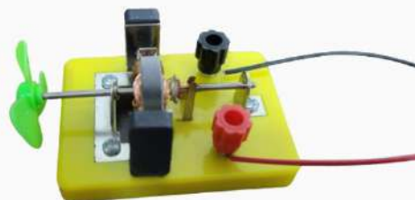
FIGURA 15 - Ímãs externos sendo colocado com polos iguais entre a bobina.
