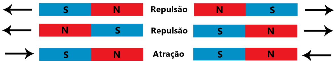
Figura 4 - Relação entre as forças de atração e repulsão dos polos magnéticos.
