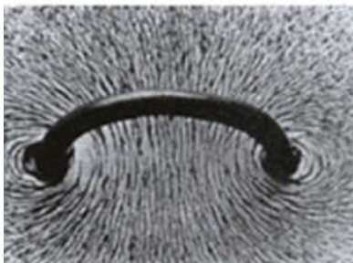
Figura 28 - Representação das linhas de campo magnético de em uma espira por limalha de ferro
