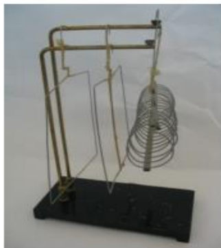
Figura 14 - Modelo de Ampère para observar a interação entre correntes e condutores lineares e em espiral (solenóide)
