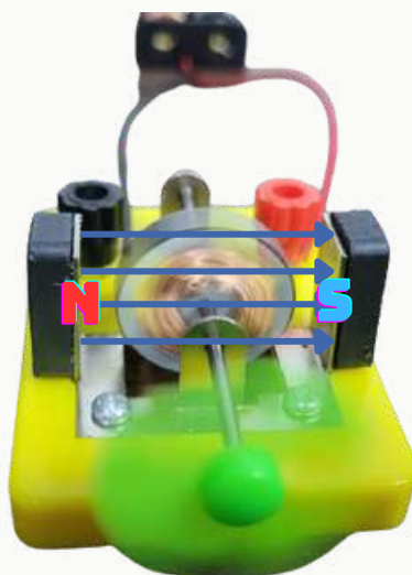
FIGURA 16 - Hélice girando devido ao campo magnético externo.
