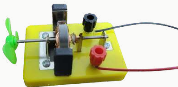
FIGURA 15 - Ímãs externos sendo colocado com polos iguais entre a bobina.
