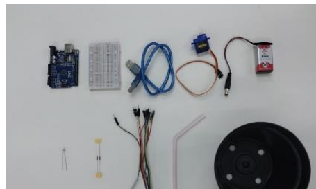
Figura 8: Materiais para simulador Arduino fototropismo.
