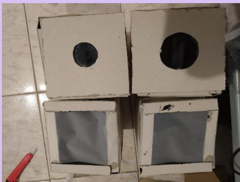
Figura 16- Construção de uma câmera escura com materiais de baixo custo.
