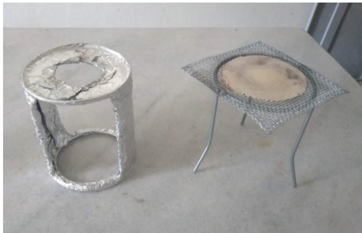
Figura 2: Suporte construído com lata de leite revestido em papel alumínio e o conjunto tripé e tela de amianto usado no laboratório de química.
