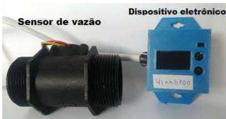
Figura 26 - Medidor eletrônico de vazão de água.
