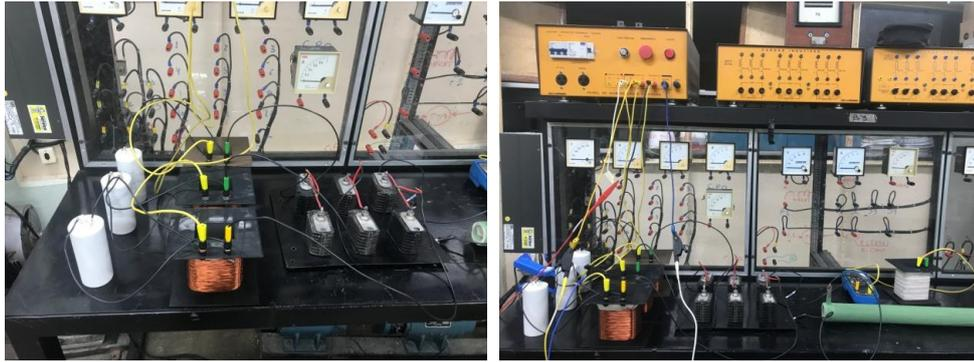
**Figura 36:** Ensaio do Circuito Ressonante com Retificador Carregado
