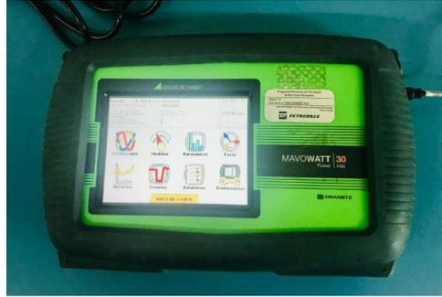
**Figura 23:** Analisador de energia
