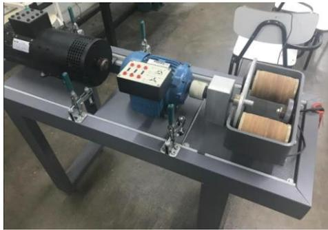
**Figura 21:** Conjunto motor e freio Foucault
