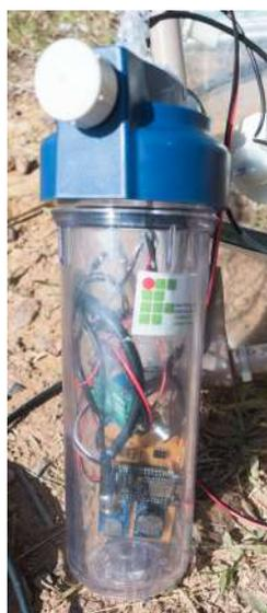
Figura 27 – Filtro com os componentes eletrônicos dentro
