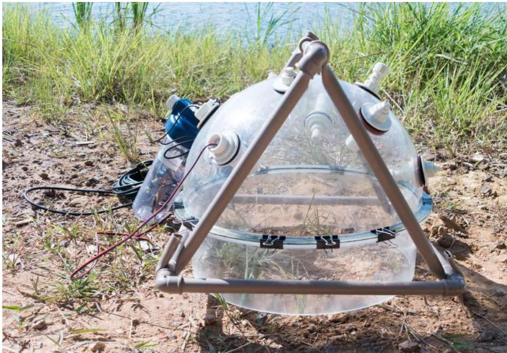
Figura 23 – Visão lateral do Bell Jar com o seu suporte e seu calço
