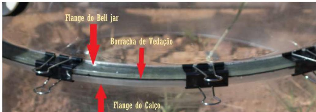
Figura 24 – Bell jar e calço acoplados
