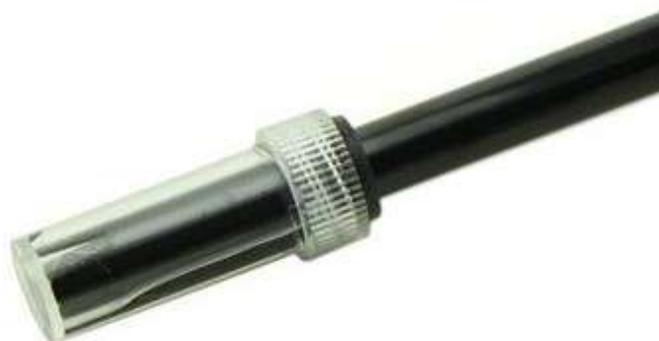
Figura 17 – Eletrodo em sua solução de armazenamento
