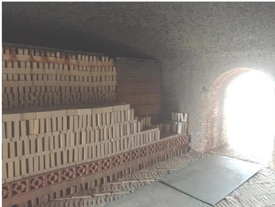
**Figura 17 - Interior do forno cerâmico com carga disposta em filas**
