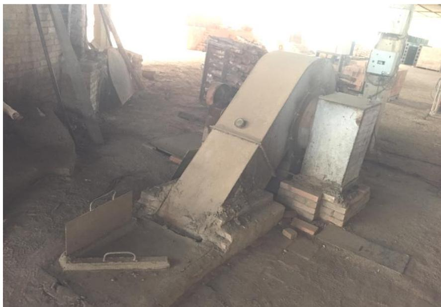
**Figura 3 – Mecanismo utilizado para aproveitamento do calor entre os fornos**
