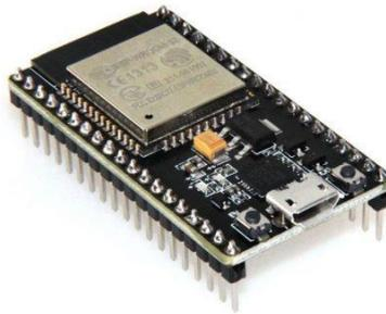
*Figura 4 - NodeMCU ESP 32*
