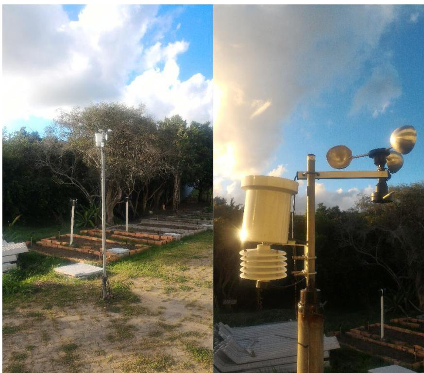
Figura 34 - NMA instalado próxima a Horta Agroecológica (E) e detalhe do pluviômetro e anemômetro (D)
