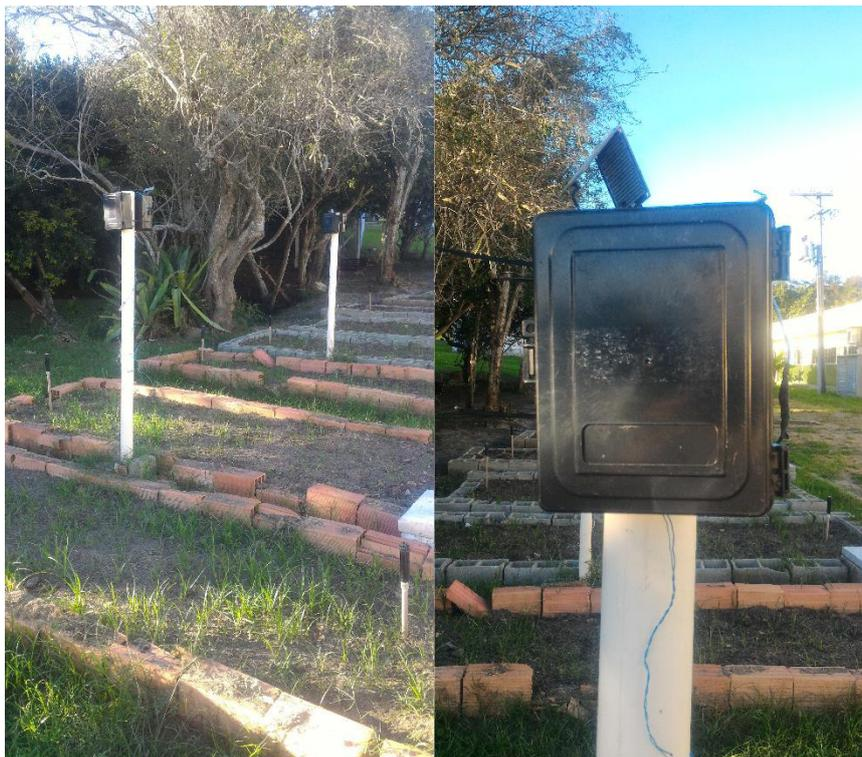
Figura 33 - NMLs instalados nas leiras (E) e detalhe do NML encapsulado (D)
