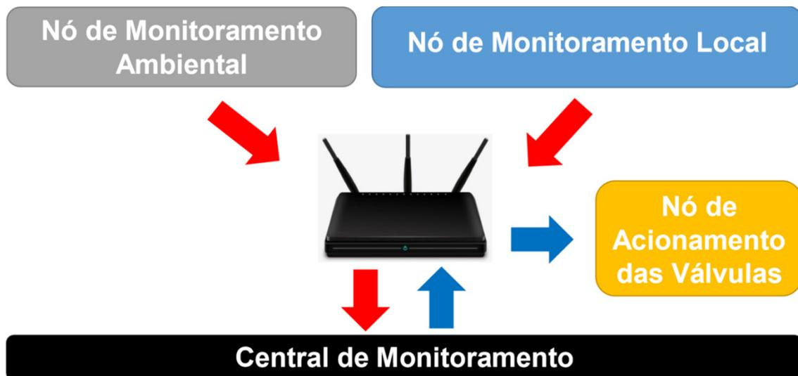
Figura 11 - Esquema de Funcionamento do Sistema de Gerenciamento de Irrigação
