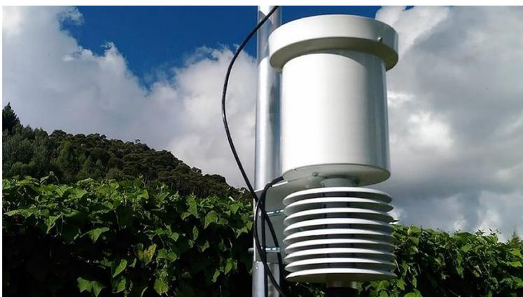
*Figura 7 - Pluviômetro digital
