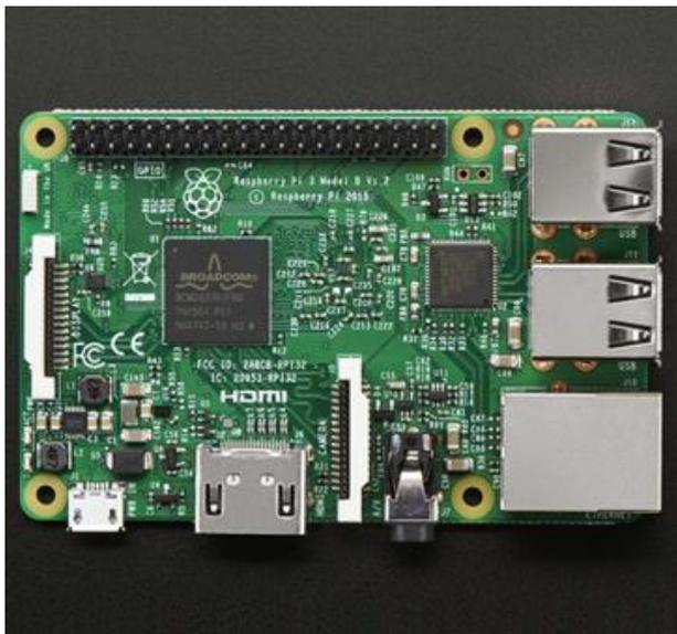
Figura 9 – Computador Single-board Raspberry Pi modelo 3B
