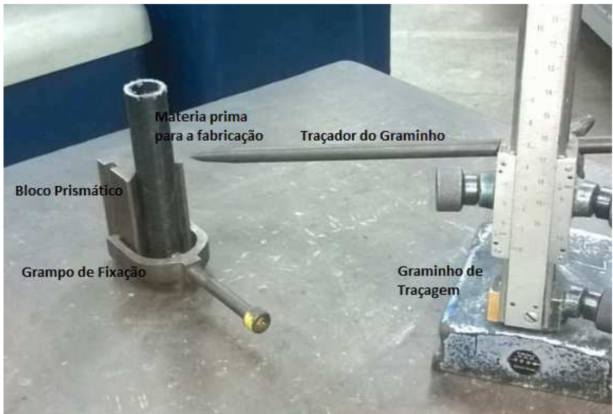
Figura 28 – Elementos de traçagem para ajustagem mecânica
