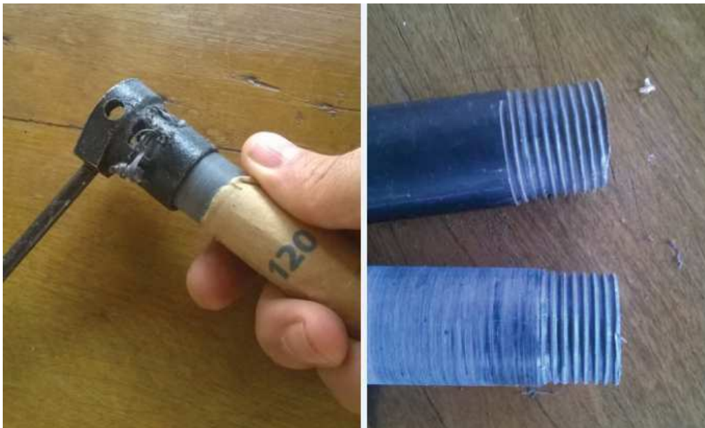
Figura 27 – Abertura de rosca no amostrador
