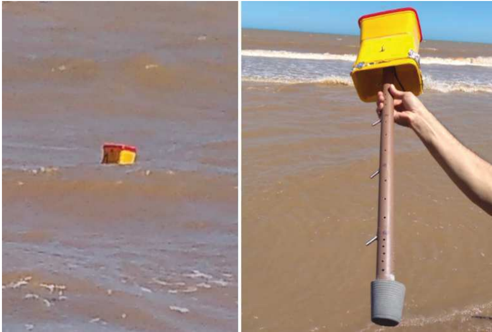
Figura 18 – Pré-teste de flutuabilidade e protótipo da unidade flutuante
