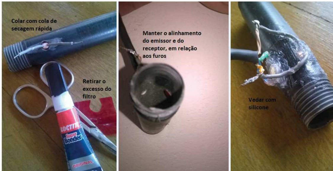
Figura 30 – Sequência de montagem do emissor e receptor de luz
