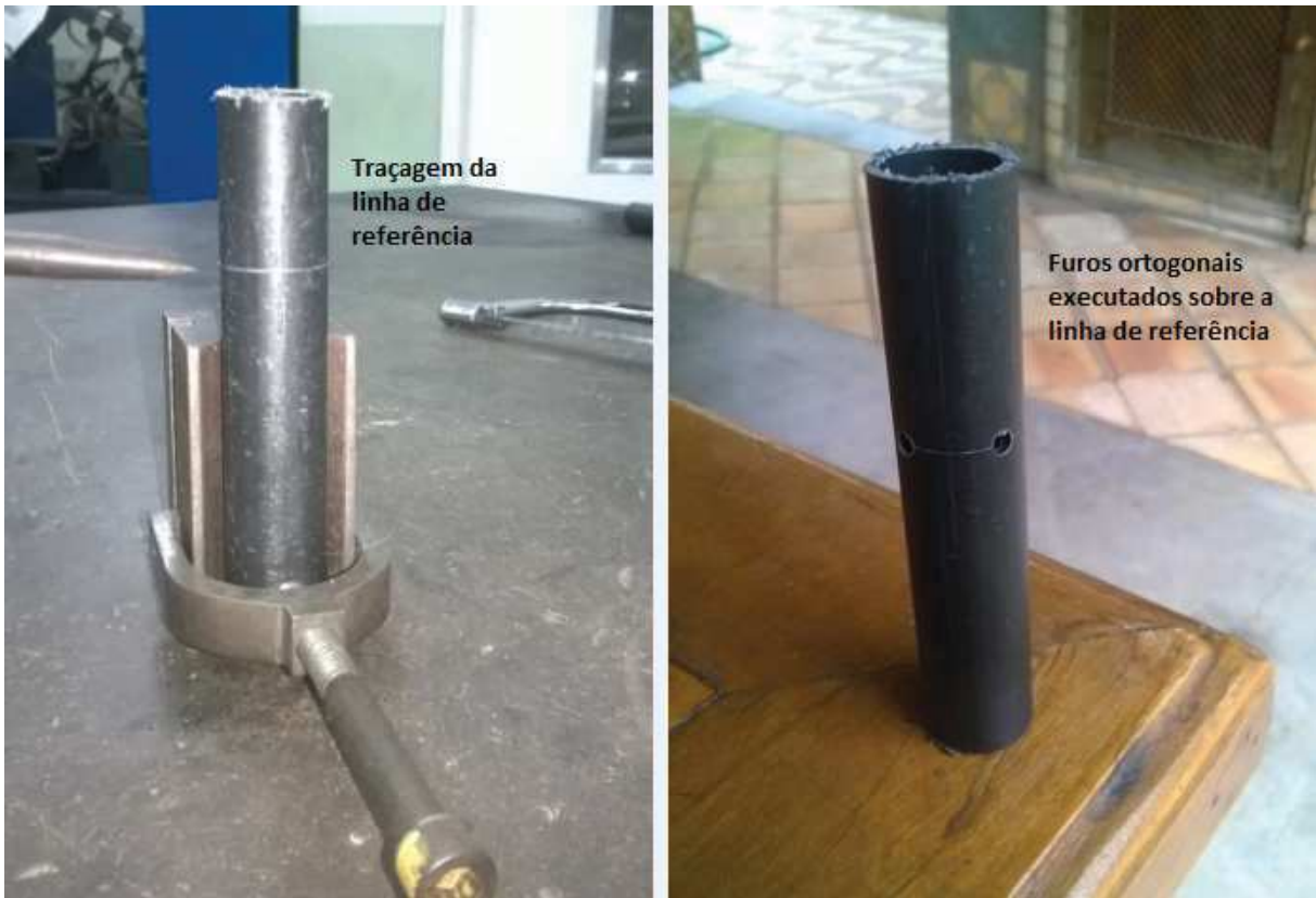
Figura 29 – Processo de traçagem de linha de referência e resultado da furação
