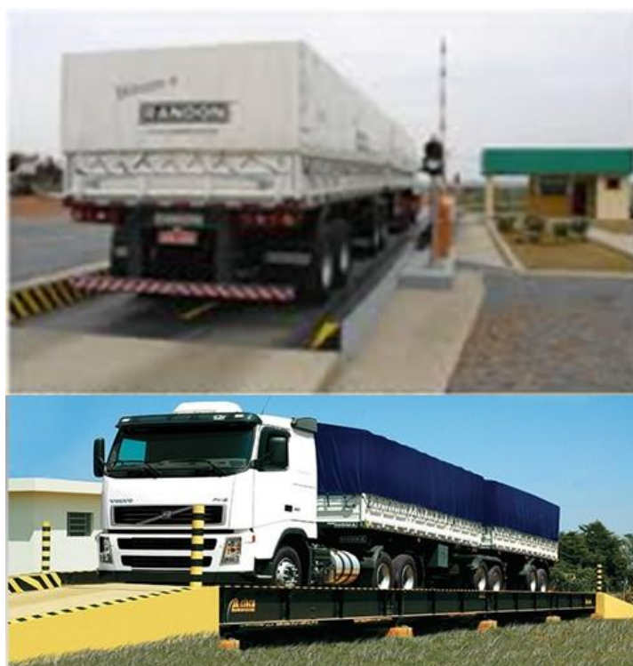
Figura 6: Balanças Rodoviárias para Portos digitalizados. Fonte: Klitex (2019).
